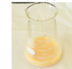
塩化銀が沈殿した後、変色
